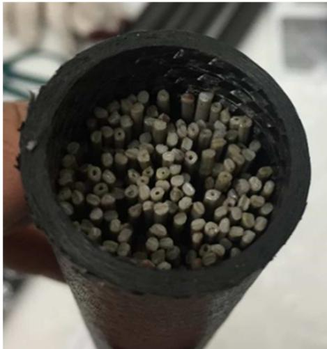
中空部材に挿入された曲げ加工用芯材
