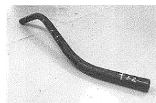
写真7 3次元形状曲げ加工パイプ
